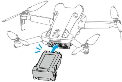
Нажмите на текстурированную часть пряжек аккумулятора по бокам аккумулятора, чтобы извлечь его из отсека.
