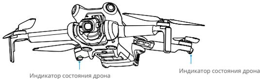
**Когда дрон включен, но моторы не работают,** индикаторы состояния самолета будут отображать текущее состояние системы управления полетом. Дополнительную информацию об индикаторах состояния дрона см. в таблице ниже.
