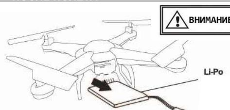
**Важно!** После полётов всегда отключайте Li-Po аккумулятор от модели, если оставить аккумулятор подключённым к модели он может переразрядится и выйти из строя! Хранить аккумуляторы в разряженном состоянии губительно для них! Так же после зарядки отключайте аккумулятор от зарядного!
