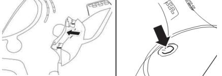
Установите аккумулятор в отсек и подключите его к модели. Включите квадрокоптер: нажмите кнопку включения.
