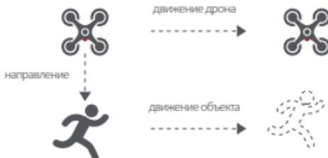
В режиме Lock дрон будет зависать на месте, если выбранная скорость полёта равна 0, и будет наблюдать за целью на  $360^\circ$ . Пользователь также может регулировать скорость полёта, и дрон будет облетать цель на определённом расстоянии.
