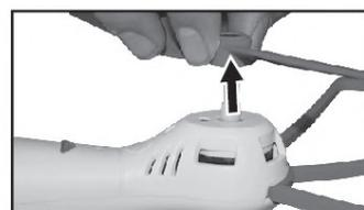
4. Потяните пропеллер вверх и снимите его с вала.
