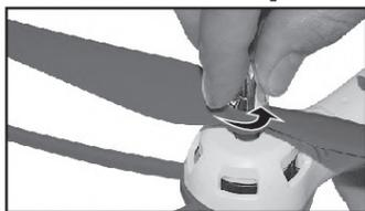
1. Открутите обтекатель пропеллера в направлении против часовой стрелки как показано на рисунке.
